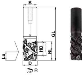
Die absolute Topklasse, wenn es um Fein-Fügebearbeitungen von ausrissintensiven Plattenwerkstoffen geht. Die Speedy-Geometrie mit 54° AWS ermöglicht eine zuverlässige Verhinderung von Ausrissen an der Ober- und Unterseite von Plattenwerkstoffen. Die Z2 Variante ist für mittlere bis schnelle Vorschubbereiche geeignet.
