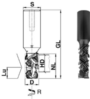
Die absolute Topklasse wenn es um Fein-Fügebearbeitungen von ausrissintensiven Plattenwerkstoffen geht. Die Speedy-Geometrie mit 54° AWS ermöglicht eine zuverlässige Verhinderung von Ausrissen an der Ober- und Unterseite von Plattenwerkstoffen. Die Z1 Variante ist für langsame Vorschubbereiche geeignet.
