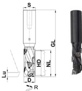
„Einer für alles“ beschreibt die neue Referenzklasse, den Konstantin®Mini FinishCut Nutschaftfräser. Dieser Fräser ist hervorragend geeignet zur Bearbeitung von Sperrhölzern und furnierten Materialien. Aber auch in Standard-Plattenwerkstoffen erzielt diese Fräserart ein rekordverdächtiges Kantenfinish. Für langsame Vorschubbereiche bis max. 8m/min. funktioniert dieser Fräser mit fast aussrissfreiem Ergebnis!
