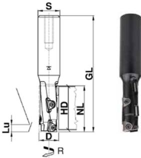
Das „Arbeitsstier“ unter den DIA-Nutschaftfräsern könnte die richtige Bezeichnung für diesen Fräser Typen lauten. Mit dem bewährten Konstantin® Mini System ausgerüstet, ist dieses Werkzeug geeignet für alle standardisierten Fräsarbeiten die am BAZ mit eher langsameren Vorschüben anfallen können.
